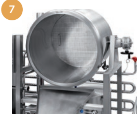
Lauter tun tilting device for spent grain extraction. Renversement cuve de filtration pour extraction drêche.
