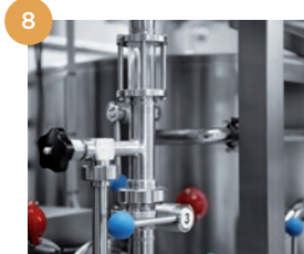
Lauter run off control with micrometric valve and inspection sight-glass. Régulation de filtration avec vanne micrométrique et verre regard.
