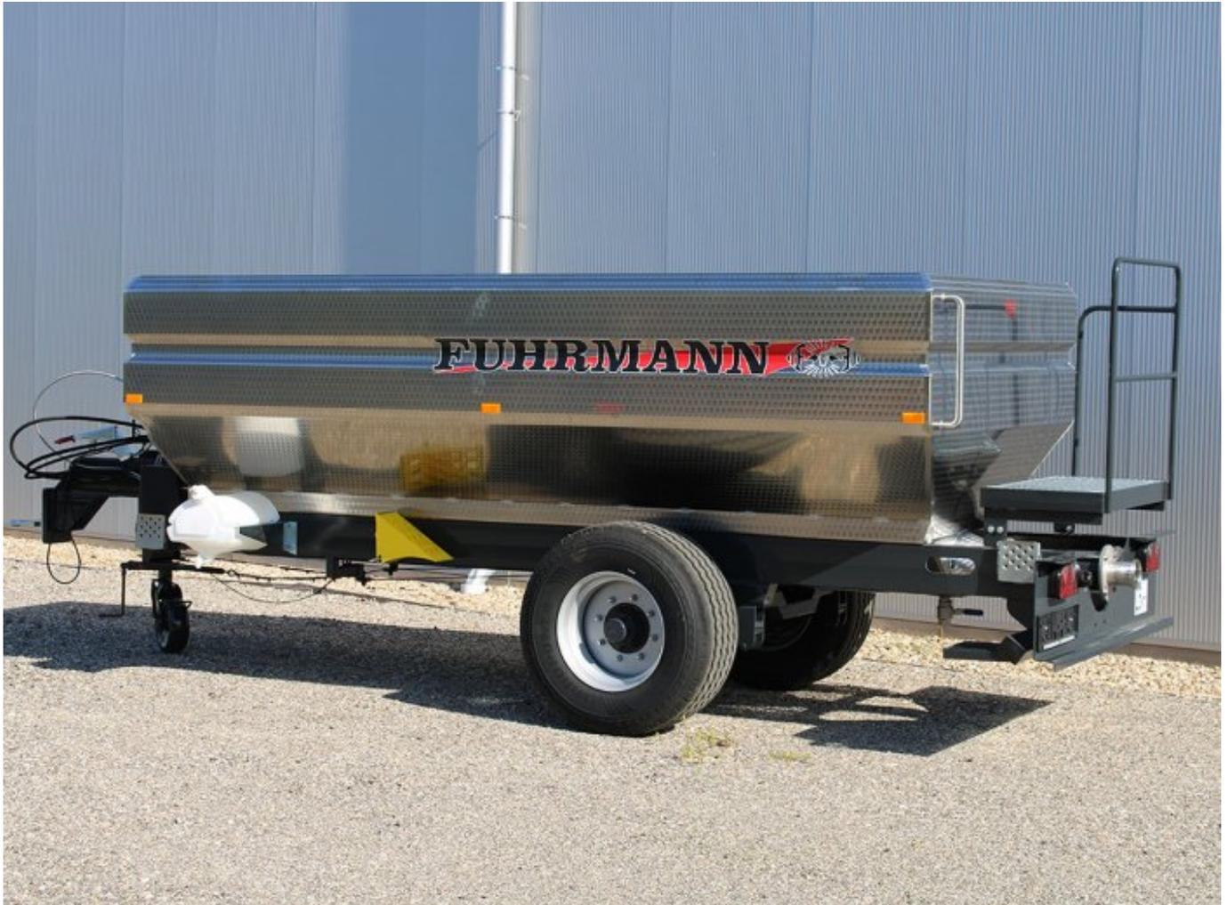
Edelstahlanhänger zum Transport und Entladen von Trauben. Das Entladen der Trauben erfolgt mit einer Schnecken- oder Exzenterpumpe. Der Anhänger wurde für den schonenden und effizienten Transport von Trauben sowohl bei der manuellen als auch bei der maschinellen Ernte konzipiert.
