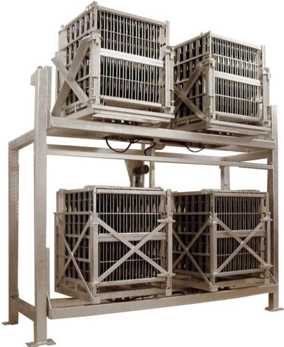
Das Gerät dient zum automatischen Drehen von Sektflaschen, die in speziellen Stahlkäfigen untergebracht sind, während der Remuage-Phase, d. h. dem allmählichen Abschütteln des Hefesediments. Automatisch gesteuerte Geräte. Das Gerät besteht aus verzinktem, feuerverzinktem Stahl.
