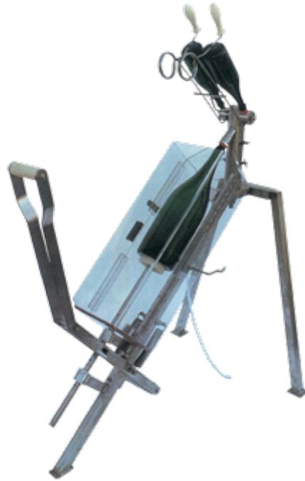
Diese Maschine ist zum Umfüllen großer Flaschen ausgestattet.
