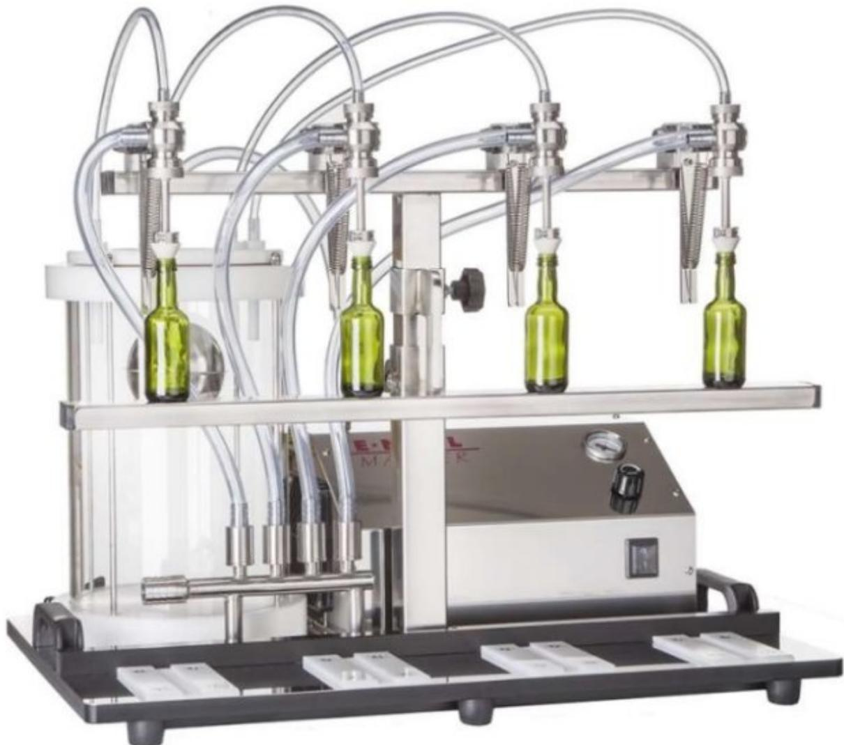
ENOLMASTER Vakuümfüller 4-stellig mit Edelstahl -Füllventilen und Edelstahlgehäuse und Pyrex-Behälter Vakuümbehälter.
