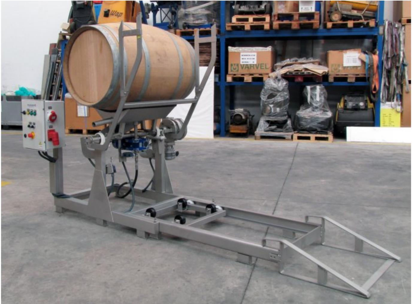
Das Gerät besteht aus Edelstahl. Garantiert eine vollständige Reinigung. Bedienfeld mit Timer. Geeignet für Fässer mit einem Fassungsvermögen von 225 bis 500 Litern
