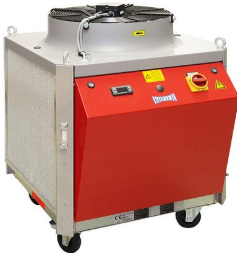
Die Anlagen der Typenreihe Chilly MAX zeichnen sich vor allem durch ihre kompakte Bauweise und einfachste Installation aus. Sie sind auf Rollen fahrbar und dadurch sehr flexibel einsetzbar. Wie die Chilly-Geräte sind sie mit einem vollhermetischen Kompressor sowie einem kompletten Kühlwasserkreislauf mit Wassertank und Kreiselpumpe ausgestattet. Zusätzlich enthalten die Chilly MAX-Geräte einen Elektroheizstab, der im Edelstahltank integriert ist und der auch das Erwärmen von Gebinden ermöglicht.
