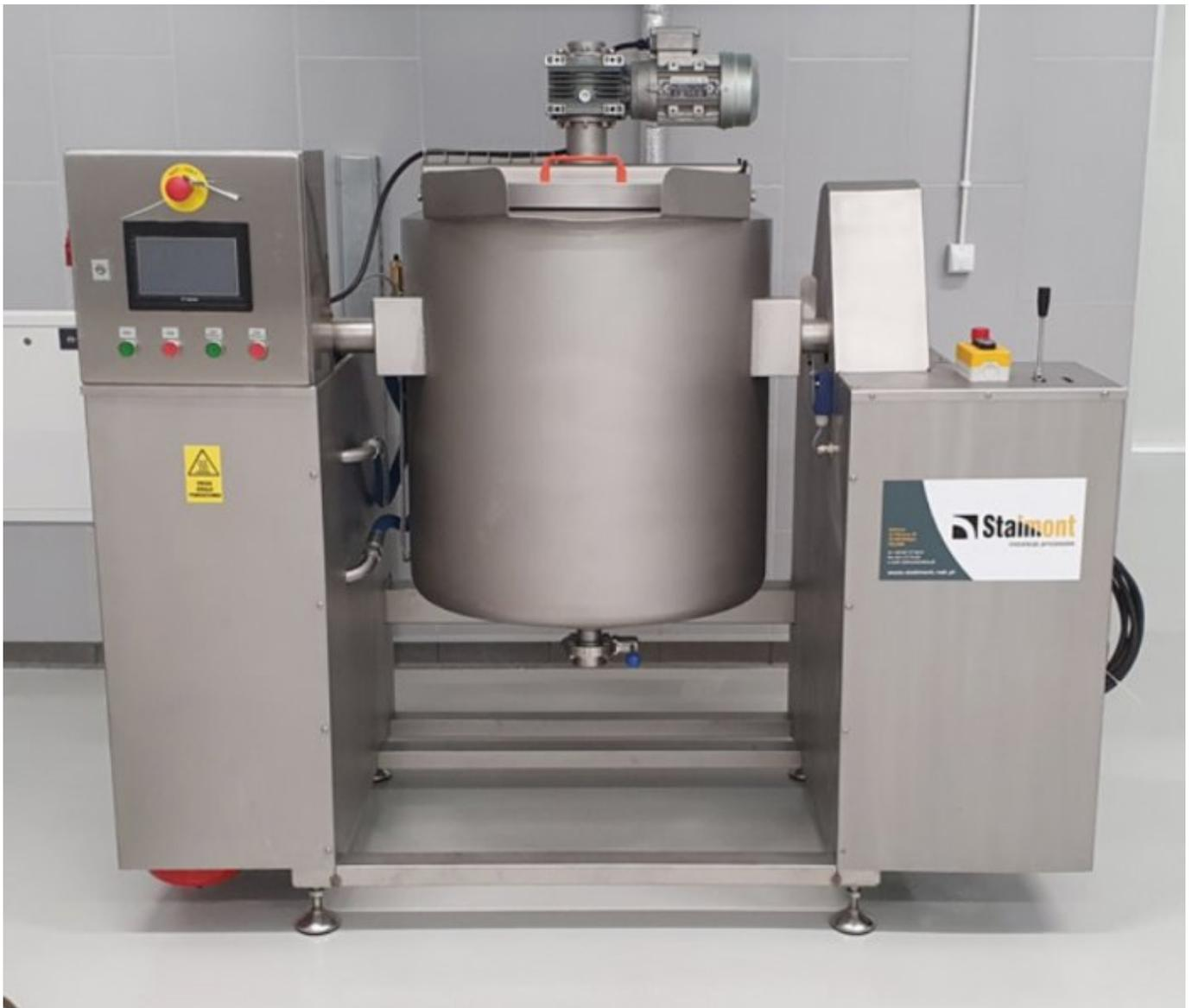
Kochkessel ist ein Gerät zur thermischen Verarbeitung Lebensmittelprodukte, z. B. Marmeladen, Konfitüren, Sirupe usw. Der installierte mechanische Rührer mit niedriger Drehzahl ermöglicht das Mischen des Produkts während des Erhitzens.
