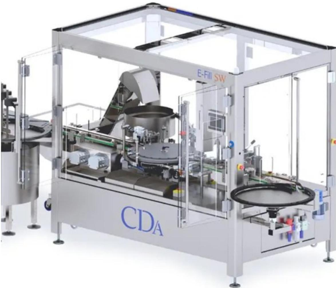
Automatischer Monoblock zum Abfüllen, Verschließen und Etikettieren. Der E-Fill SW Monoblock von CDA ist auf maximale Effizienz und Vielseitigkeit in einer vollautomatischen Abfülllinie ausgelegt.
