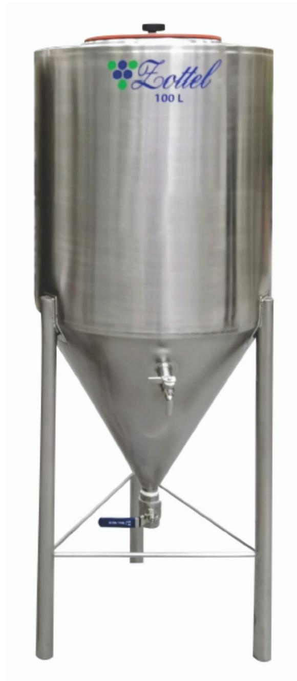
Konische Tanks sind aus Edelstahl AISI304, Hochglanz hergestellt. Sie sind ideal für die Fermentation von Bier und anderen Flüssigkeiten mit Sedimenten. Der konische Boden von 60° ermöglicht das Absetzen von Hefen und Sedimenten am Boden des Tanks. Der untere Auslauf ist mit dem Edelstahlkugelhahn 1" ausgestattet, der eine einfache Reinigung und Entleerung ermöglicht. Die Tanks sind mit einem Deckel und einem lebensmittelechten Gummiausgestattet.
