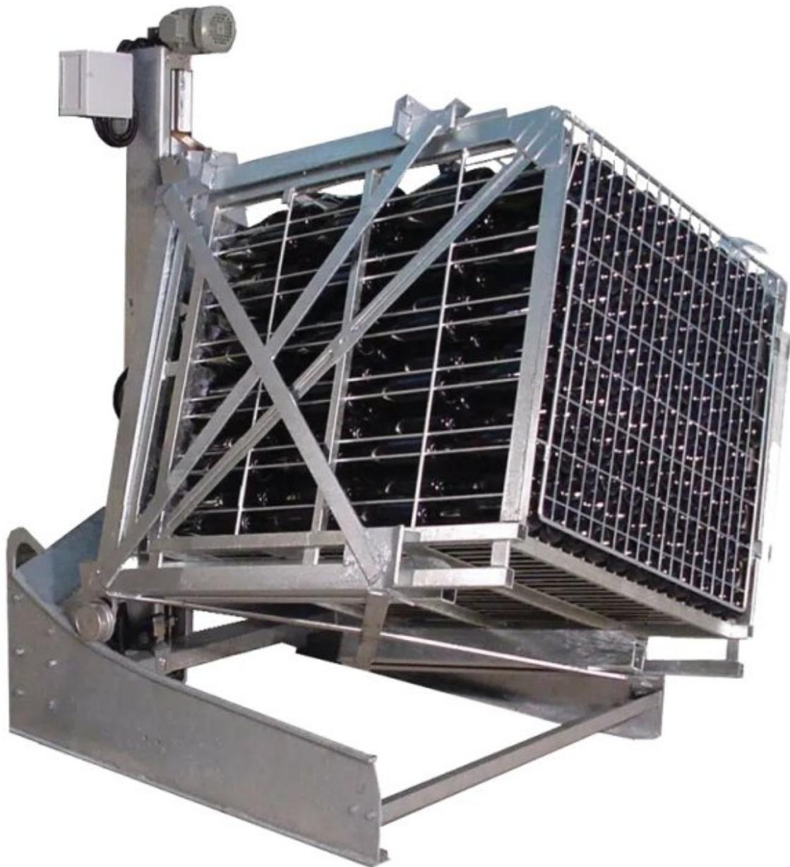
Die Gyropalette® mit einem Käfig ist eine Rüttelmaschine, die für die meisten Keller, insbesondere für kleine, geeignet ist. Es ist für das Rütteln von 504-Flaschen-Kartons ausgelegt und gewährleistet problemlos das automatische Rütteln Ihrer Schaumweine.
