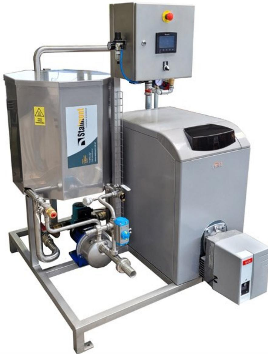
Der Pasteur ist für die thermische Verarbeitung von Fruchtsäften und Pürees konzipiert – der zuvor gepresste Saft wird einem Puffertank zugeführt und von dort zu einem Rohraustauscher transportiert, wo die Pasteurisierung stattfindet.
