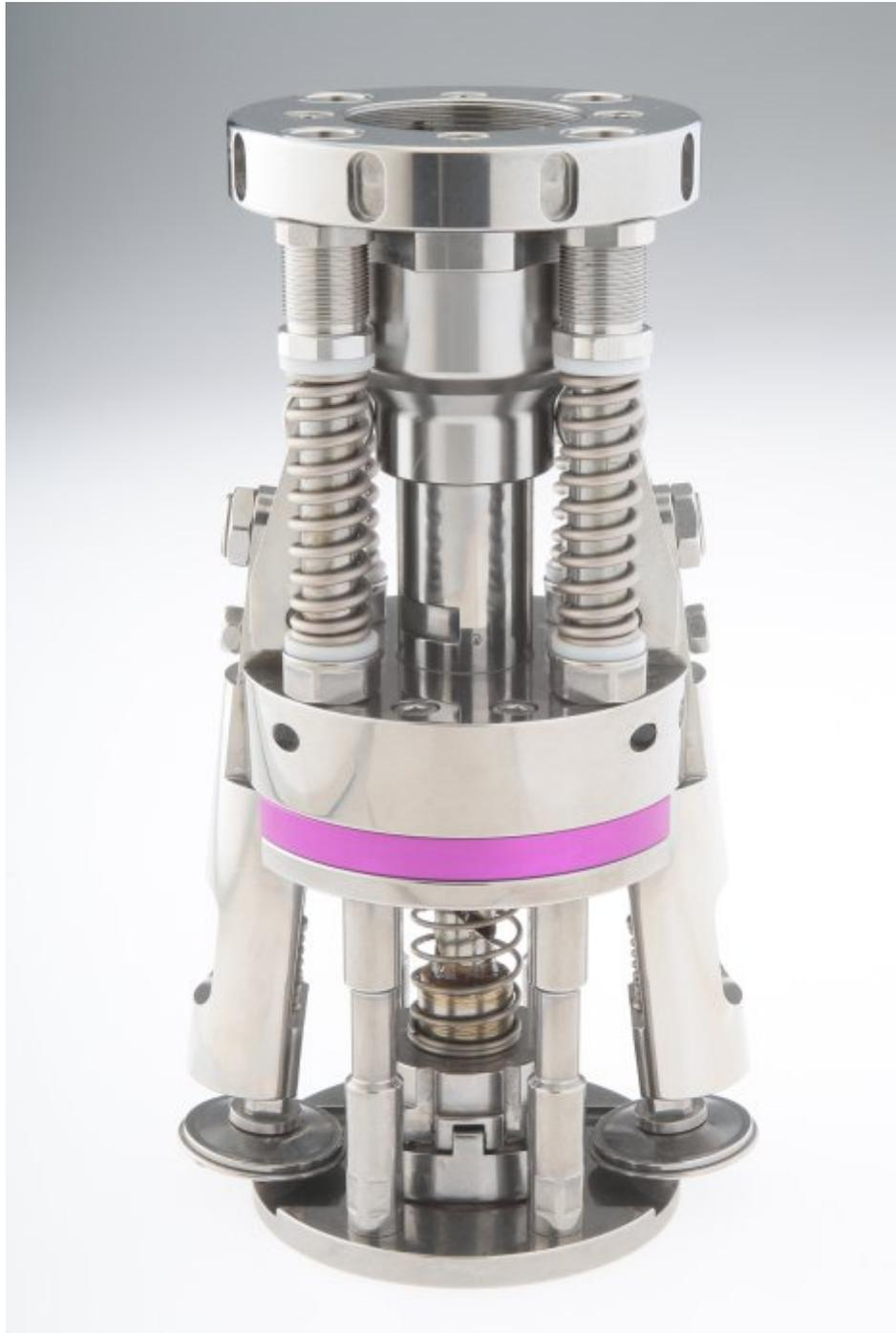
Spezieller kombinierter Verschließkopf mit einstellbarem Drehmoment, mit zwei vollständig aus Edelstahl gefertigten Armen, ausgestattet mit einer patentierten mechanischen Beschleunigungsvorrichtung und einer mechanischen Zange mit drei Sektoren für spezielle kombinierte Verschlüsse.
